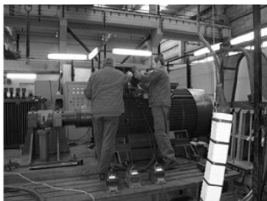
Rys. 2. Pomiar momentu rozruchowego silnika o mocy 1 MW i napięciu 6 kV (fot. materiały Energotest-Diagnostyka)
