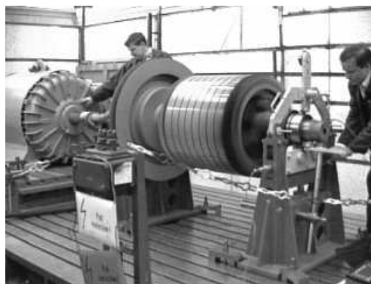
Rys. 4. Wyważarka rezonansowa, wyważanie wirnika silnika indukcyjnego 6kV o mocy 1 MW (fot. materiały Energotest-Diagnostyka)
