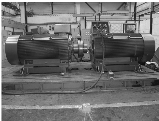
Rys. 1. Próba obciążeniowa na płycie silników o mocy 1 MW o napięciu zasilania 6 kV (fot. materiały Energotest-Diagnostyka)
