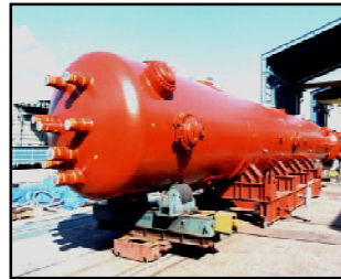
Moisture Separator Re-heater (MSR)
