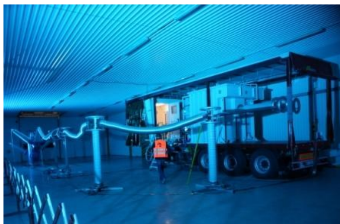
Fot. 5 – miejsce próby z wykorzystaniem systemu pomiarowego trzeciej generacji DAC MV20 60 kV
