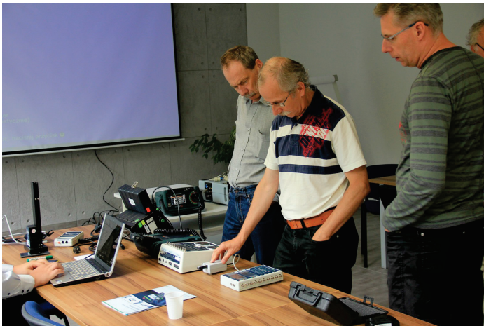
Fot. Przyłączanie symulatora „pacjenta EKG” przed pomiarami
