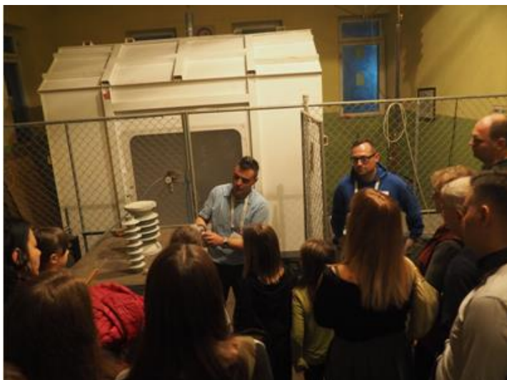
Fot. 12. Prezentacja badań izolatorów kompozytowych z zastosowaniem komory solnej.
