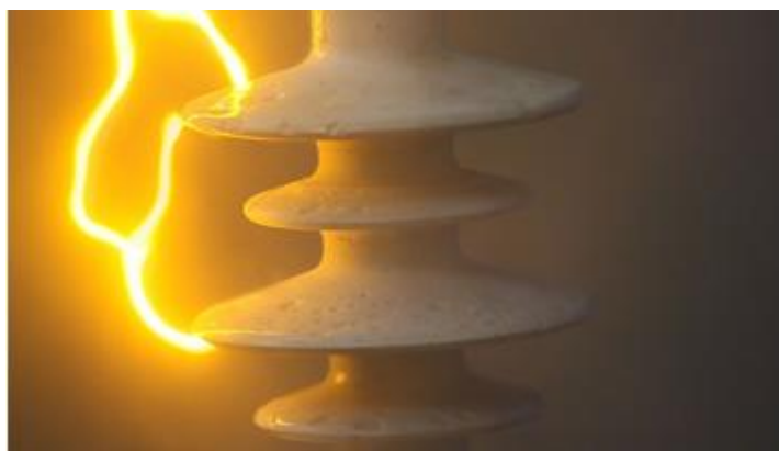
Fot. 14. Wyładowanie na izolatorze kompozytowym podczas prób w komorze solnej.
