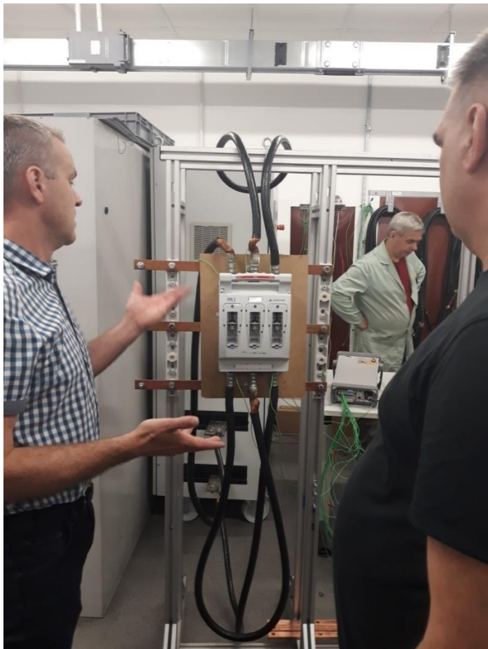
Fot. 14. Prezentacja rozłącznika bezpiecznikowego typu RBK-2 - firmy Aparator.
